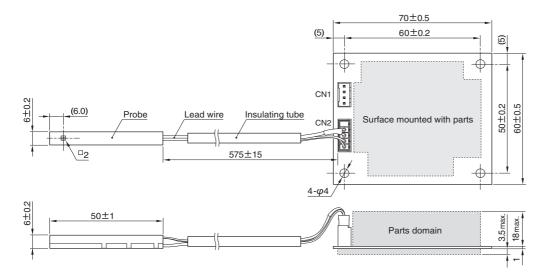
CN1 DF1BZ-4P-2.5DSA HRS Connector (I/O pins)
