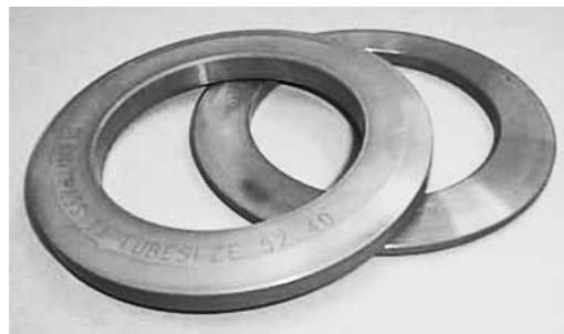
Обычно используются в качестве замены последнего металлического лезвия с целью ослабления электромагнитных помех в области сварки. Обладают чрезвычайно высокой износостойкостью. С целью компенсации износа рассчитаны на многократное шлифование.
