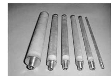
Серьезное влияние на качество сварки оказывает геометрическое расположение импедера по отношению к сварочным обжимным роликам, размер и конфигурацию используемого в нем феррита.
