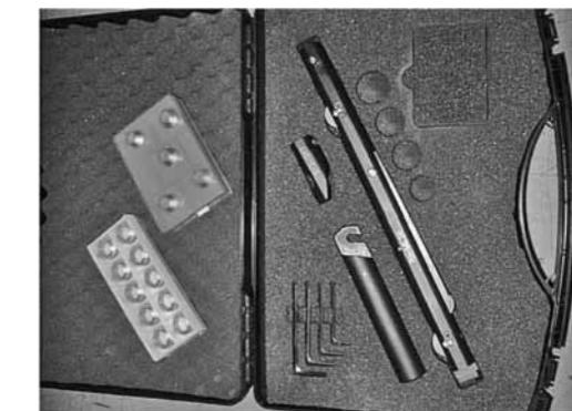
В качестве режущего инструмента применяются твердосплавные режущие кольца или режущие наконечники , выбираемые в соответствии с внутренним диаметром трубы, применяемым типом инструмента и держателя
