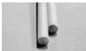
В большинстве случаев для изготовления кожухов импедеров применяется материал на основе эпоксидной смолы **Fibreglass WT912** (Зеленая линия) Для более высоких температур могут использоваться:
