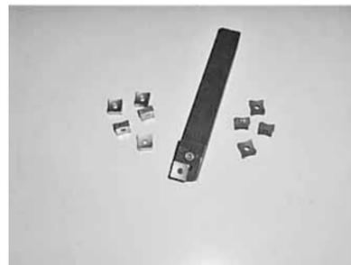
**Твердосплавные пластины и держатели средней мощности для внешней зачистки труб толщиной до 4 мм**
