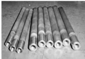
Импедеры для высокочастотной сварки труб с проточной системой охлаждения наиболее широко используются по сравнению с другими типами импедеров.
