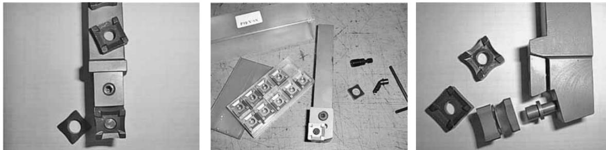
**Твердосплавные пластины и держатели большой мощности для внешней зачистки труб толщиной более 4 мм**
